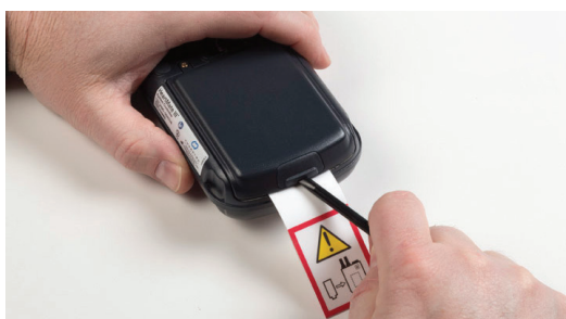
Utilisation du levier pour soulever le couvercle
